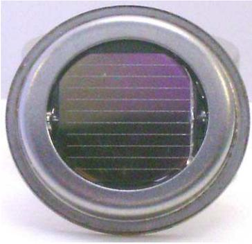
PHOTO DIODE PLANAR SILICIUM(PHOTOVOLTAÏQUE)
