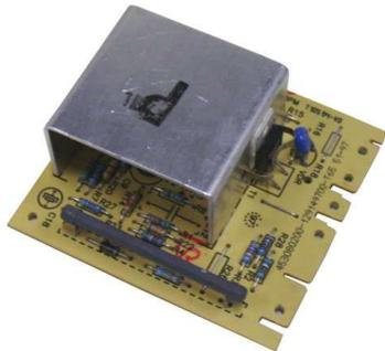
Module électronique, platine minuterie, 13 voies
