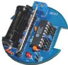
Les kits présentés dans cette page permettent de commander individuellement sans le passage fastidieux des câbles dans les murs n'importe quel appareil électrique (éclairage, téléviseur, ordinateur, volets ...) par liaison radio codée et sécurisée (433 MHz).
