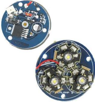
Ce kit permet d'alimenter 3 Led's de puissance 1 Watt "LUXEON" avec une régulation protégeant celles-ci de l'emballement thermique et donc de la destruction. Cette alimentation régulée est déclinée en deux références : l'une avec 3 Led's blanches dites "FROIDES" (5500°K ) et l'autre avec 3 Led's blanches dites « CHAUDES » ( 3800°K ) pour une application se rapprochant plus de l'éclairage traditionnel.
