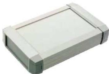
Boîtier en profilé tubulaire d'aluminium 6063, peinture époxy grise. Panneaux en ABS de haute qualité. Chaque coffret inclut 1 profilé, 2 panneaux, 4 bouchons, visserie.
