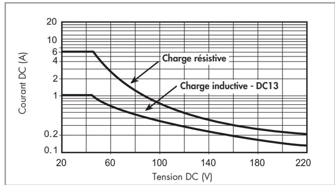
• La durée de vie électrique pour des charges résistives en DC ayant des valeurs de tension et de courant situées sous la courbe est  $\geq 100 \cdot 10^3$ .
